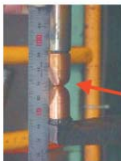
Tip角上下同心度需小(max 1.0 mm↓)
