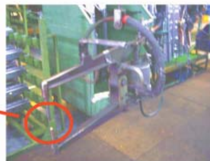
Tip角上下同心度需小(max 1.0 mm↓)
